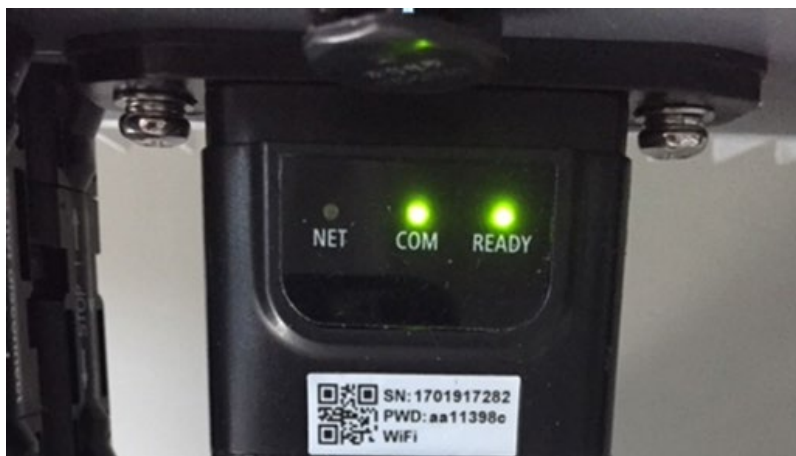
Figura 207 – Stato iniziale dei led
