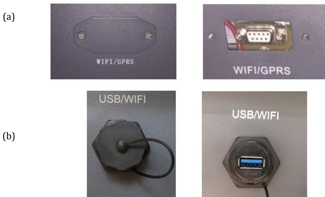
Figura 211 - Alloggiamento della scheda 4G
