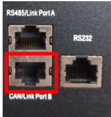
Figura 34 - Ingresso CAN del BMS SC500 e SC1000
