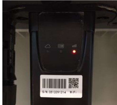
Figura 200 – Stato di comunicazione irregolare tra wifi e server remoto
