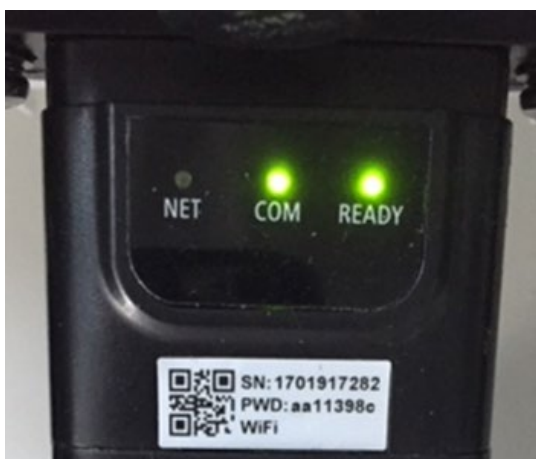
Figura 210 – Stato di comunicazione irregolare tra scheda e server remoto
