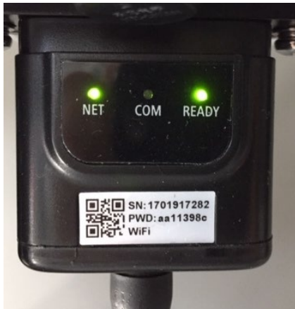
Figura 198 - Stato di comunicazione irregolare tra inverter e wifi
