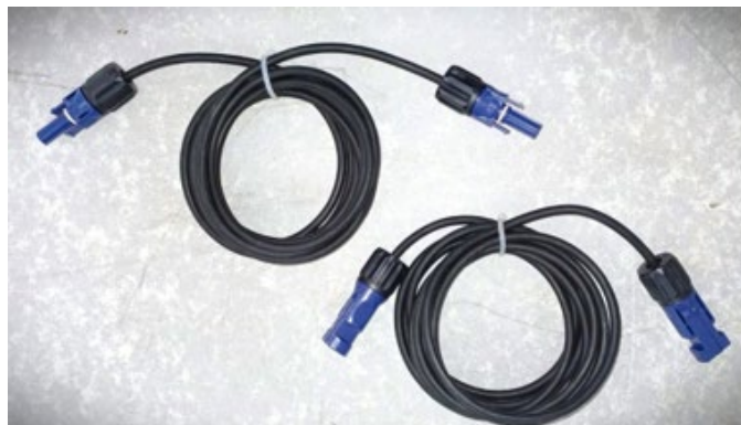
Figura 146 - Cavi potenza BDU Inverter
