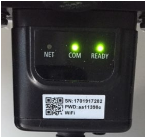
Figura 200 – Stato di comunicazione irregolare tra wifi e server remoto
