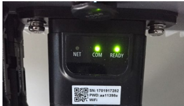
Figura 213 - Stato iniziale dei led
