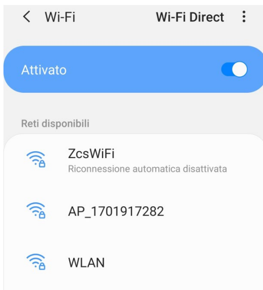
Figura 182 – Disattivazione della riconnessione automatica ad una rete
