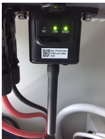
Figura 195 – Stato iniziale dei led
