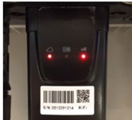
Figura 198 - Stato di comunicazione irregolare tra inverter e wifi
