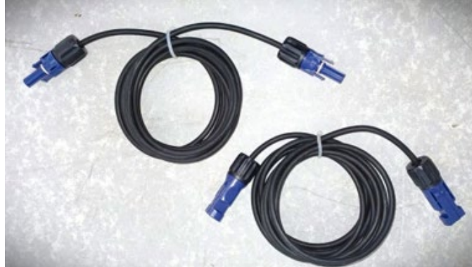
Figura 128 - Cavi potenza BDU Inverter
