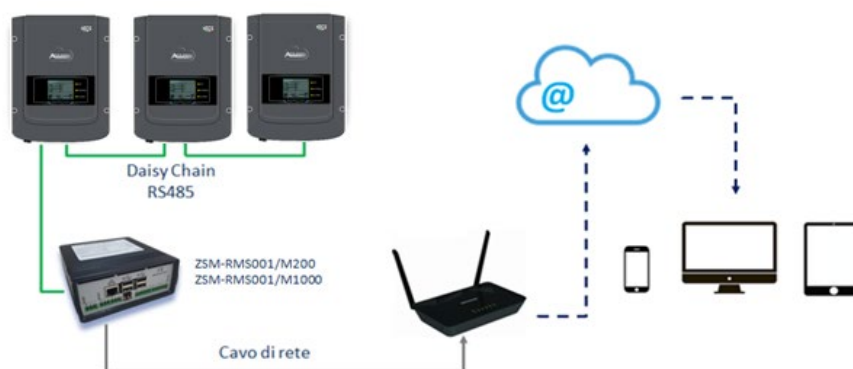
Figura 218 – Schema di funzionamento del datalogger ZSM-RMS001/M200 / ZSM-RMS001/M1000
