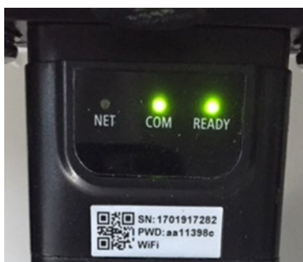
Figura 216 – Stato di comunicazione irregolare tra scheda e server remoto
