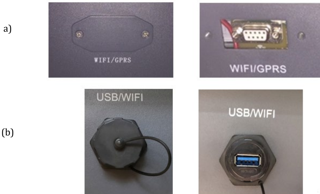
Figura 179 - Alloggiamento della scheda wifi esterna
