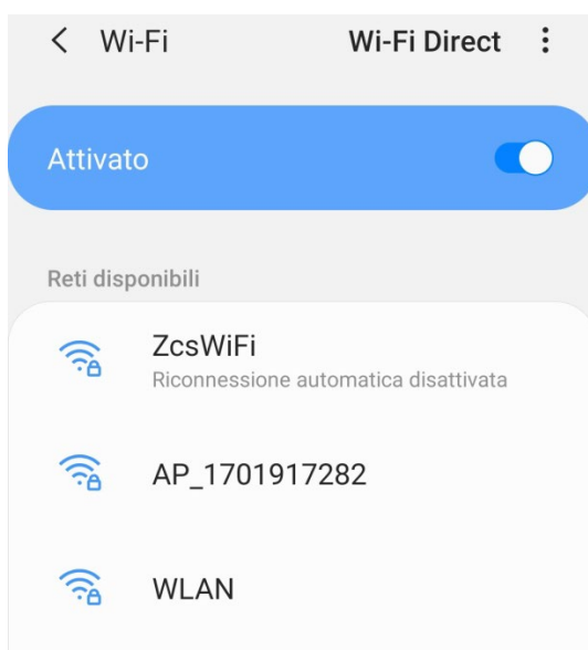
Figura 229 - Disattivazione della riconnessione automatica ad una rete
