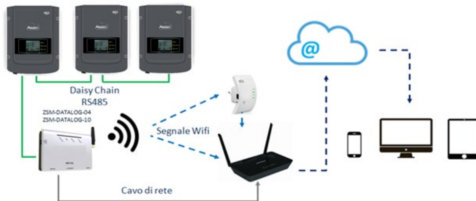
Figura 217 – Schema di connessione del datalogger ZSM-DATALOG-04 / ZSM-DATALOG-10
