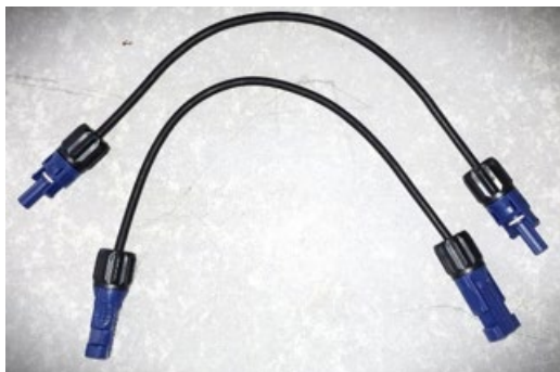
Figura 142 - Connettore potenza fra moduli batteria
