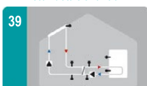
39 Solare con accumulo e scambiatore per grandi sistemi
