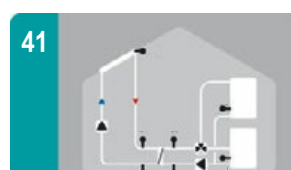
41 Solare con 2 accumuli, scambiatore e valvola per grandi sistemi
