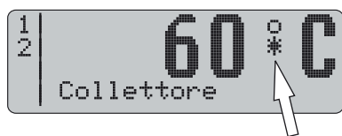
Fig. 6-4 Indicazione di esercizio con protezione antigelo attiva
