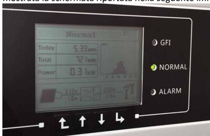
**Figura 1 - Stato di normale funzionamento dell'inverter**
