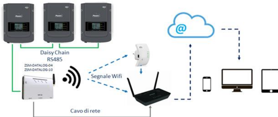
Figura 83 – Schema di connessione del datalogger ZSM-DATALOG-04 / ZSM-DATALOG-10
