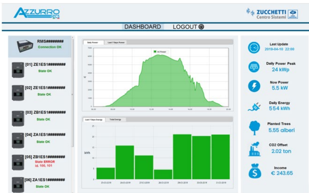
Figura 107 - Esempio di pagina di monitoraggio locale
