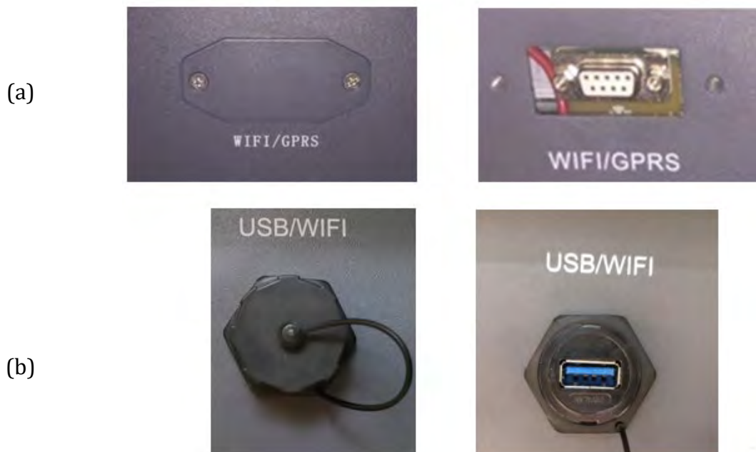
Figura 68 - Porta dell'adattatore 4G
