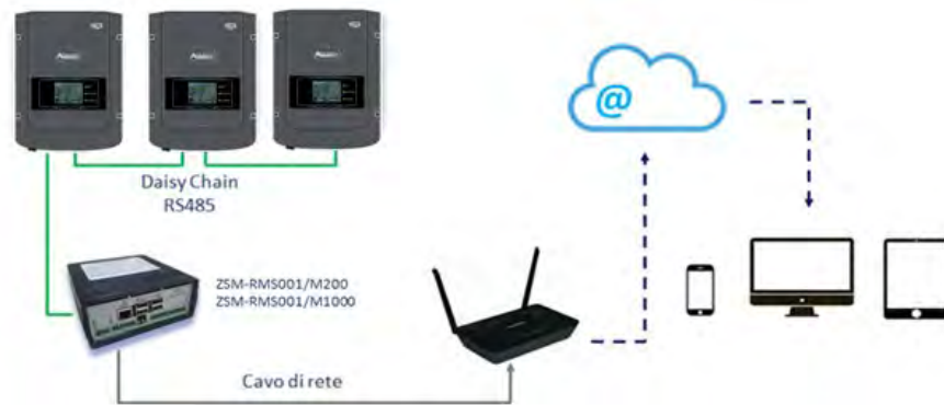
Figura 75 – Schema che mostra il funzionamento dei datalogger ZSM-RMS001/M200 / ZSM-RMS001/M1000
