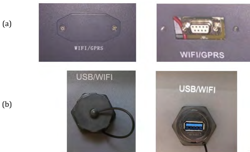
Figura 35 - Porta per adattatore Wi-Fi esterno
