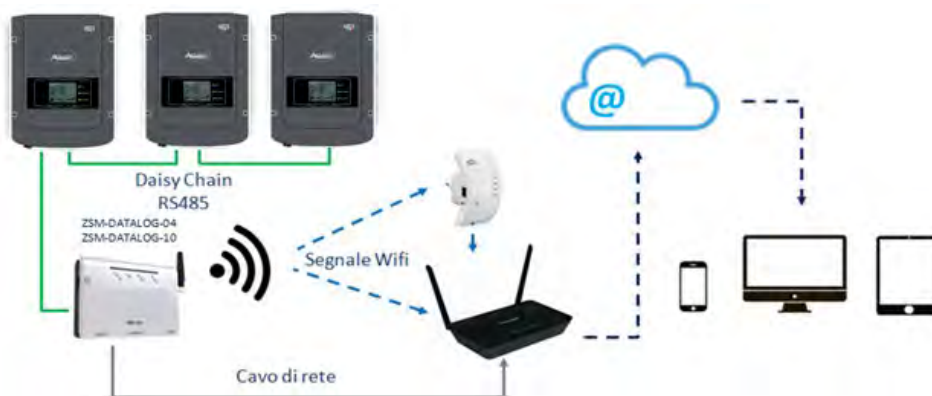
Figura 74 – Schema per il collegamento dei datalogger ZSM-DATALOG-04 / ZSM-DATALOG-10
