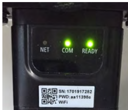
Figura 97 - Stato di comunicazione irregolare tra adattatore e server remoto
