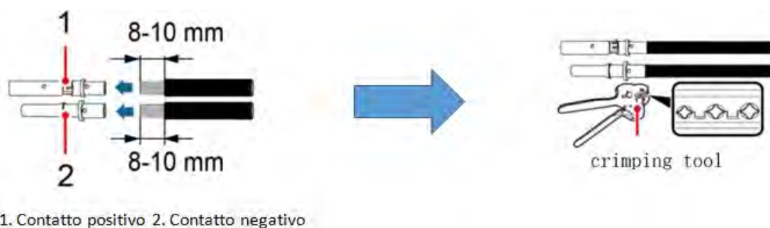
Figura 32 - Preparazione dei cavi fotovoltaici positivo e negativo
