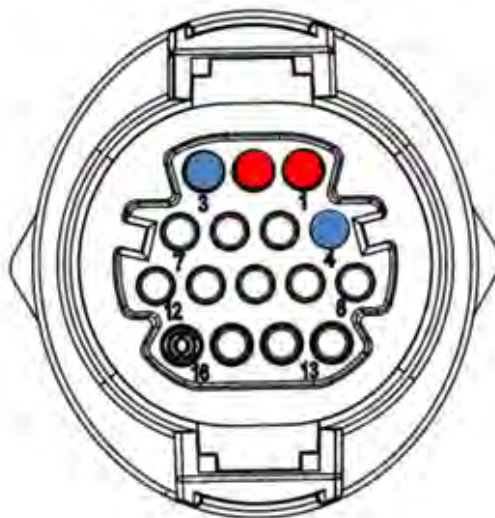
Figura 103a- Collegamento della linea seriale tramite connettore di comunicazione per 3PH HYD5000-HYD20000-ZSS
