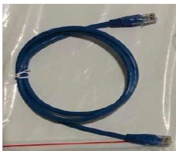
Figura 31 - Cavo di comunicazione fra batterie WeCo 5k3
