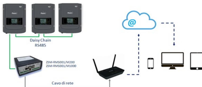
Figura129 – Schema di funzionamento del datalogger ZSM-RMS001/M200 / ZSM-RMS001/M1000
