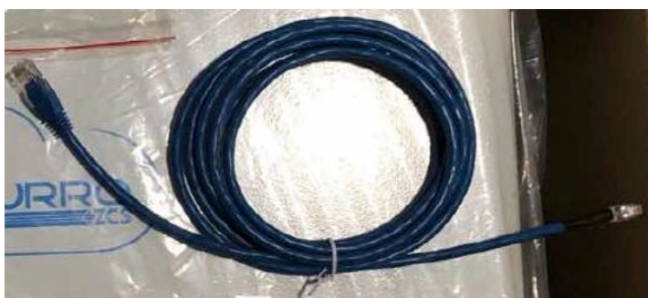
Figura 15 - Cavo di comunicazione fra inverter e batteria WeCo 4k4
