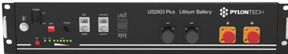
Figura 82 – Stato della batteria dopo aver posizionato lo switch POWER su ON ed aver premuto il tasto SW
