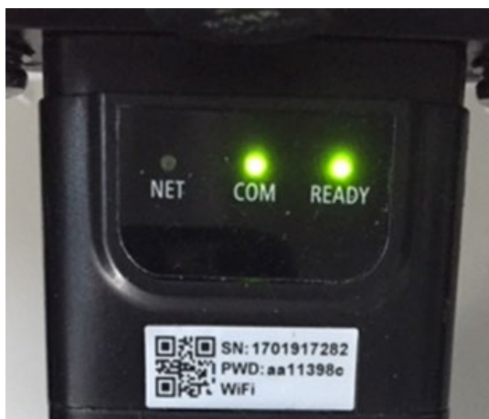
Figura 120 – Stato di comunicazione irregolare tra scheda e server remoto
