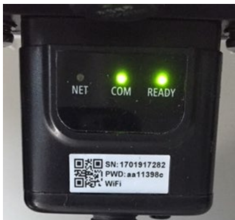
Figura 110 – Stato di comunicazione irregolare tra wifi e server remoto
