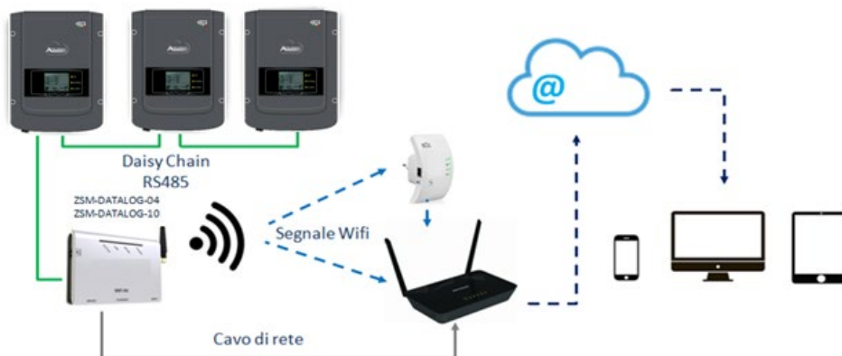
Figura 127 – Schema di connessione del datalogger ZSM-DATALOG-04 / ZSM-DATALOG-10
