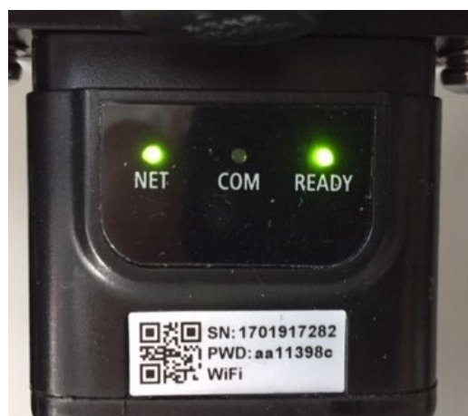
Figura 119- Stato di comunicazione irregolare tra inverter e scheda
