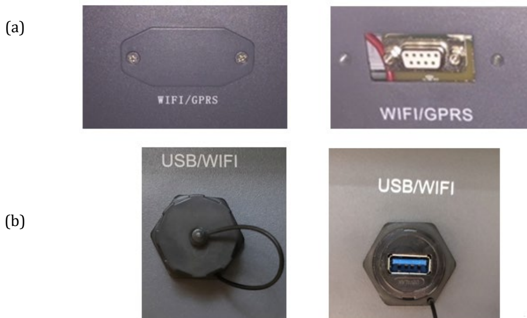
Figura 121 - Alloggiamento della scheda 4G
