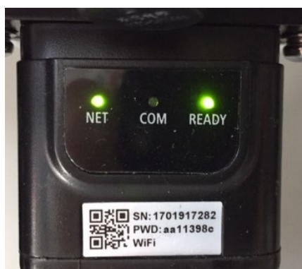
Figura 125 - Stato di comunicazione irregolare tra inverter e scheda
