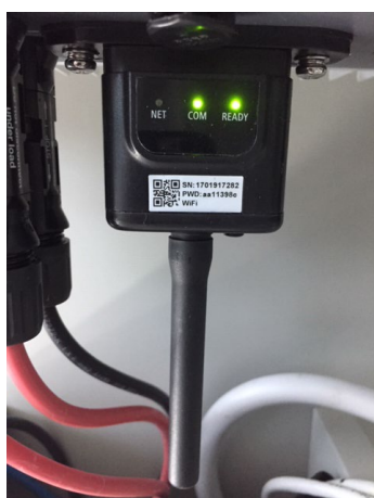
Figura 105 - Stato iniziale dei led
