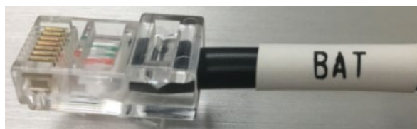
Figura 11 - Cavo di comunicazione Pylontech plug da inserire nell'ingresso comunicazione batteria
