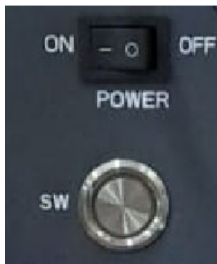
Figura 20- Pulsante di accensione della batteria AZZURRO ZSX 5120
