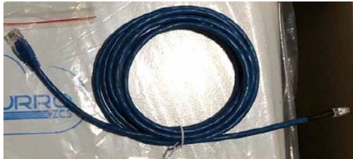
Figura 22 - Cavo di comunicazione fra inverter e batteria WeCo 4k4 PRO
