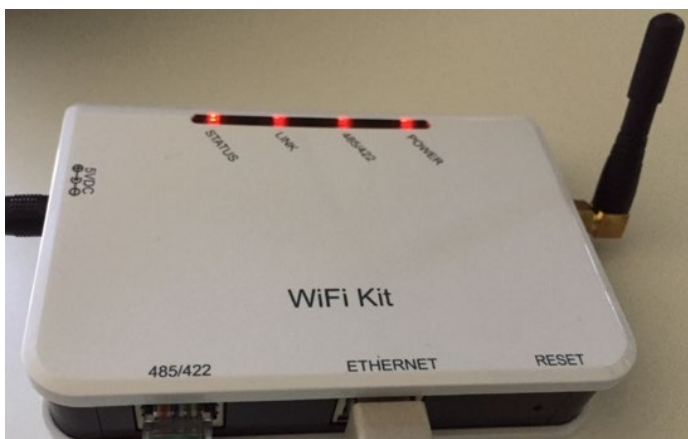
Figura 149 – Led che indicano la corretta configurazione del datalogger
