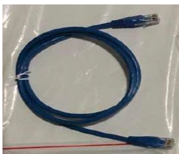
Figura 51 – Cavo di comunicazione fra batterie AZZURRO 5000 PRO
