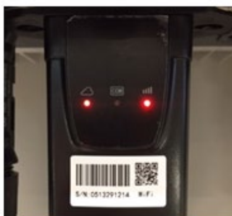
Figura 108 - Stato di comunicazione irregolare tra inverter e wifi
