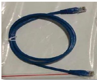
Figura 17 – Cavo di comunicazione fra batterie WeCo 4k4
