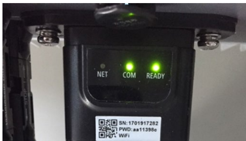
Figura 117 - Stato iniziale dei led
