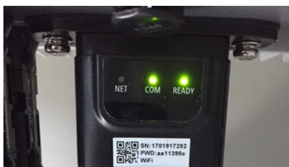
Figura 123 - Stato iniziale dei led
