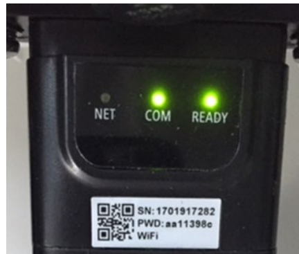
Figura 126 – Stato di comunicazione irregolare tra scheda e server remoto
