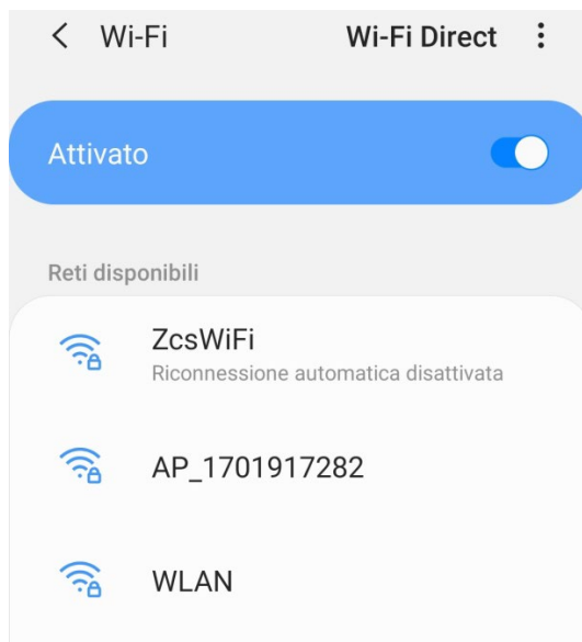
Figura 92 - Disattivazione della riconnessione automatica ad una rete
