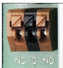
Fig. 4: Sensor box: dettaglio della morsettiera interna
